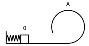
Considerando despreciable el rozamiento con las superficies, determinar la compresión mínima del resorte ( $\Delta x_{min}$ ) para que el objeto pueda recorrer toda la pista circular:
