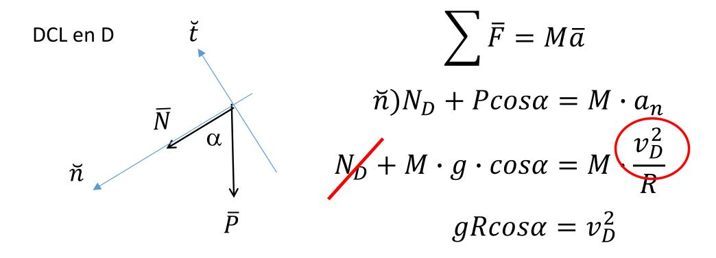
Se calcula la velocidad del punto D utilizando energía
