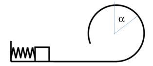
Si la compresión del resorte es  $\Delta x_0 = \frac{3}{4} \Delta x_{0min} = 0,375m$ , ¿en qué punto se desprende de la pista circular?
